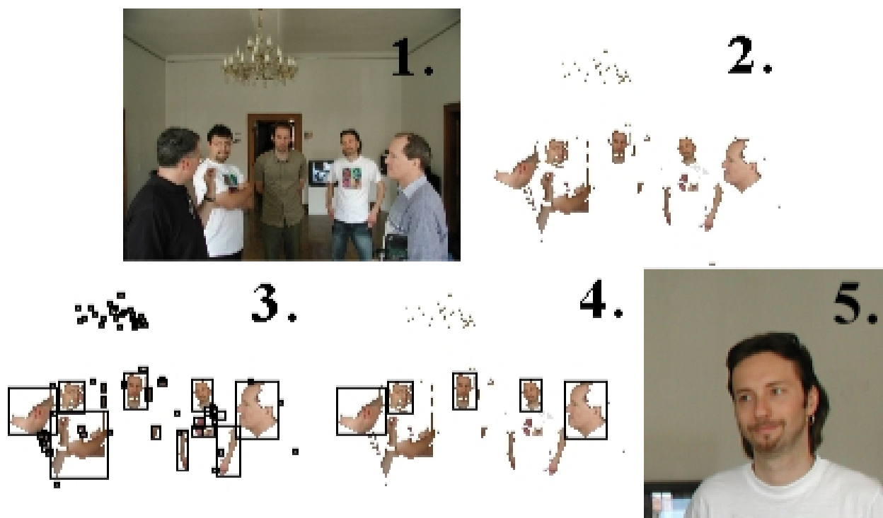
Slika 3: Koraki pri iskanju in izbiri obraza: 1) pomanjšaj resolucijo originalne slike; s tem dosežemo večjo hitrost obdelovanja slik, 2) izberi barve, ki so podobne barvi kože, 3) segmentiraj regije v barvi kože v kandidate za obraz, 4) obdrži potrjene regije kandidatov za obraz, 5) med obrazi naključno izberi enega in ga izreži iz originalne slike; pri izboru imajo večjo prioriteto večje obrazne regije in regije, ki so višje na vhodni sliki.
