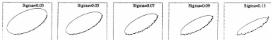
Slika 5: Rešitve algoritma za iskanje elips s pomočjo algebraične razdalje ob naraščajoči količini Gaussovega šuma; slike od leve proti desni vsebujejo od 3% do 20% šuma v podatkih (Sigma ( \sigma ) predstavlja standardno odstopanje)
